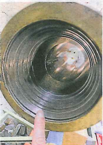
Ein Fachgebiet von Hauck: Durch das Honen werden raue Stellen in einem Zylinderrohr glatt geschliffen. FOTOS: (1) HEINWES
