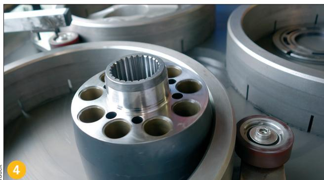
beschädigte verriefte Teile wie Zylindertrommel, Steuerscheibe und Schwenkwiege konnten auf der Läppmaschine nachgearbei-
