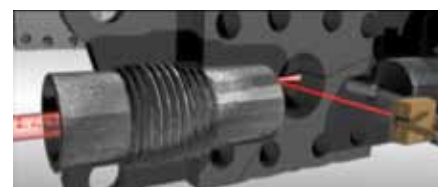
Abb. 2: Beim Erreichen der Fotozelle wird der hochpräzise Laserstrahl durch diese Fluidsäule projiziert. Die Laserdiode wirft ein Bild (Schatten) des Schmutzpartikels auf die Fotozelle.
