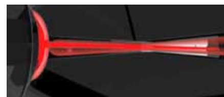
Abb. 3: Der von den Verschmutzungen im Fluid verursachte Schatten wird als messbare Veränderung der Lichtstärke ausgewertet.
